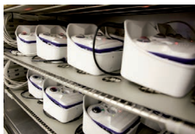
Jede Kamera wird vor der Auslieferung bei extremen Temperaturen getestet.
