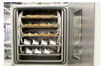
Jede Kamera wird vor der Auslieferung bei extremen Temperaturen getestet.
